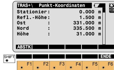
**F1** Das Absteckprogramm startet mit der polaren Absteckmethode. (siehe **ABSTECKUNG**) Speichere den abgesteckten Punkt (oder "WEITR"), um zurück ins "Trassenberechnung Plus" zu gelangen.
