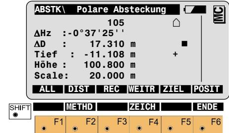
Diese Graphik erscheint nach einer Distanzmessung. Mit der Methode "Absteckung mit Hilfspunkten" wird keine Graphik von dieser Art angezeigt.
