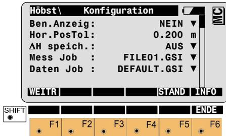
Im "Konfigurations - Editor" werden die Parameter für den weiteren Programmablauf bestimmt:
