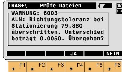
**F6** Wird "NEIN" gewählt, erscheint ein Display mit der Frage "Mit der Prüfung der Trasse fortfahren"?. Bei "NEIN" kehrt die Anzeige ins Menü "TrassenDaten wählen" zurück. Bei "JA" setzt das Programm mit der Prüfung der anderen Dateien fort. Wenn keine weiteren Warnungen erscheint, wird das Programm mit dem Display "Station & Achsabstck" fortfahren.
