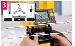
Lorsque le niveau électronique est centré, les flèches sont remplacées par des repères de contrôle.
