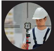
A l'aide du télescope, superposer le réticule et le centre du prisme.
