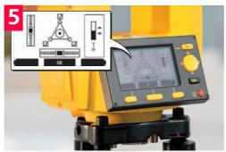
Lorsque le niveau électronique est centré et trois repères de contrôle sont indiqués, l'instrument a été nivelé parfaitement. Appuyer sur OK pour confirmer.
