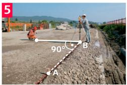
Guider le support de réflecteur dans et le long de la ligne de visée du télescope.
