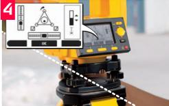
Tourner la dernière vis calante pour centrer le niveau électronique pour le second axe. Des flèches indiquent le sens de rotation de la vis calante.
