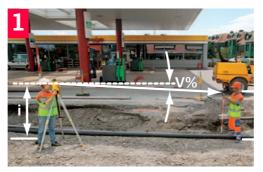
Mettre l'instrument en place et le niveler sur un point le long de la ligne droite dont on veut déterminer l'inclinaison. Positionner une tige à un second point le long de cette ligne.
