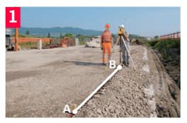
Mettre l'instrument en place et le niveler au-dessus du point B.
