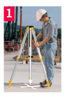
Ajuster la hauteur des jambes du trépied de manière à pouvoir travailler dans une position confortable. Positionner le trépied audessus du point repéré au sol en le centrant aussi bien que possible.
