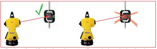
Incliner la partie mobile du prisme plat correctement.
