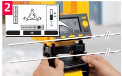
Tourner les deux vis calantes pour centrer le niveau électronique de cet axe. Des flèches indiquent le sens de rotation des vis calantes.
